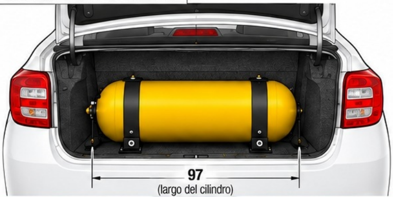
ESPECIFICACIONES DEL TANQUE DE GNV 50 LITROS
